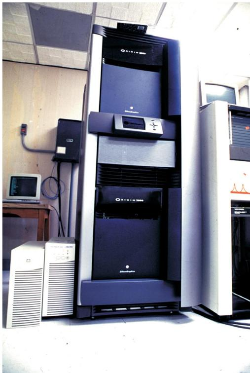
formado por 20 nodos, cada uno con cuatro procesadores Opteron de 1.75 Ghz y 4Gb de RAM, para una eficiencia nominal de 280 GFlops.
